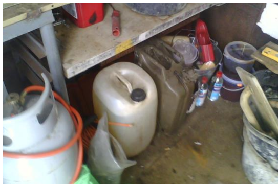
Pilnas degvielas kannas tiek uzglabāta kopā ar degošiem materiāliem
