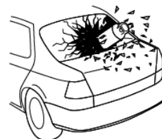
5. Nostiprināts, nepareizi novietots balons
